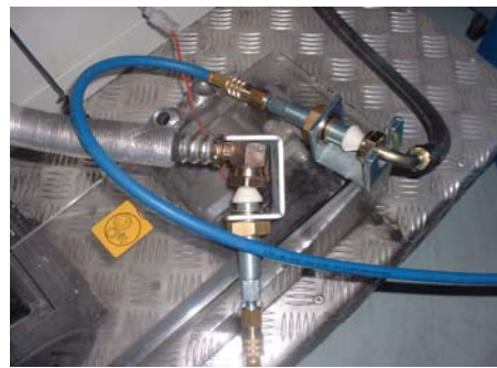
Bild 5 – Die Adapter des Satzes an die Rohre schließen, die an den Kompressor nicht geschlossen sind
